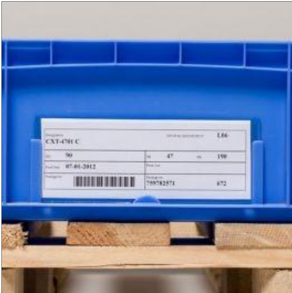
Abbildung A 2: Beispiel Supermarkt mit Kanban-Karten
