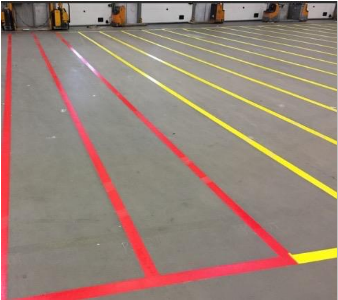
Abbildung A 4: Beispiel Lagerflächenmarkierung mit standardisierten Farben
